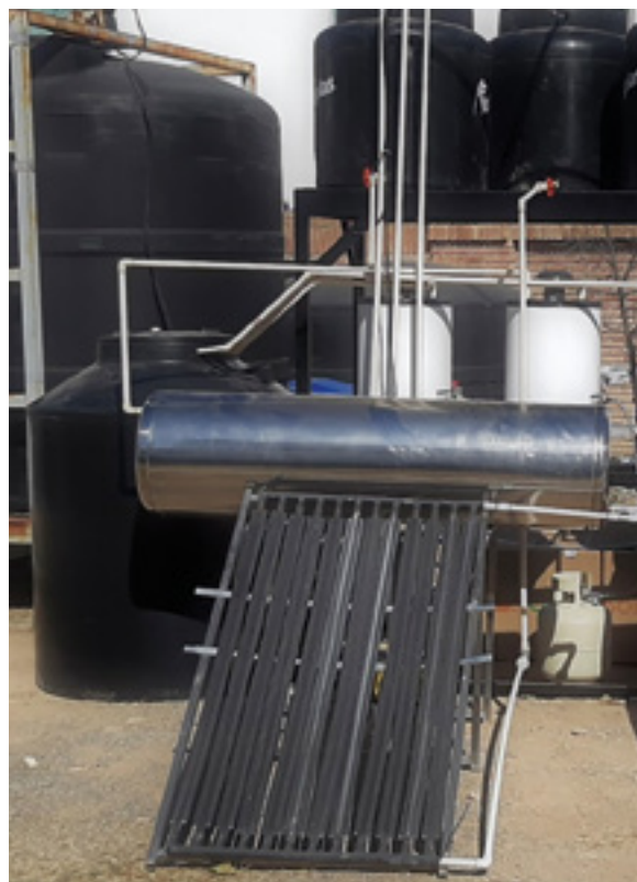
FIGURA 2. ESTACIÓN DE PRUEBAS PARA COLECTORES SOLARES EN EL CIQA.
